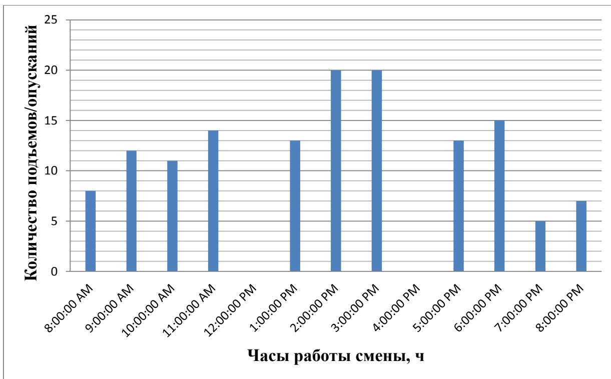
Рисунок 1.2 – График сменного режима работы одностоечного подъемника (типовой)
