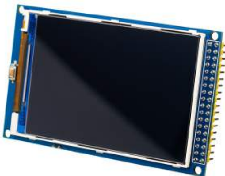
Рисунок 3.25 - Цветной графический TFT-дисплей 480×320 / 3,2”
