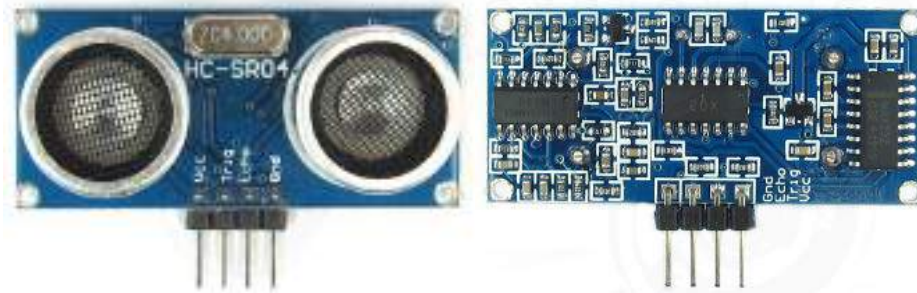
Рисунок 3.21 - Внешний вид HC-SR04
