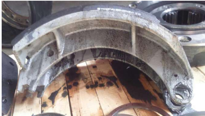
Рисунок 3.6 – Колодка тормозная 6520-3501095 автомобиля КамАЗ 65221
