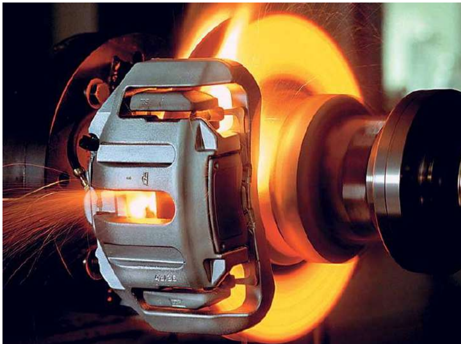
Рисунок 2.15 – Перегрев тормозной системы
