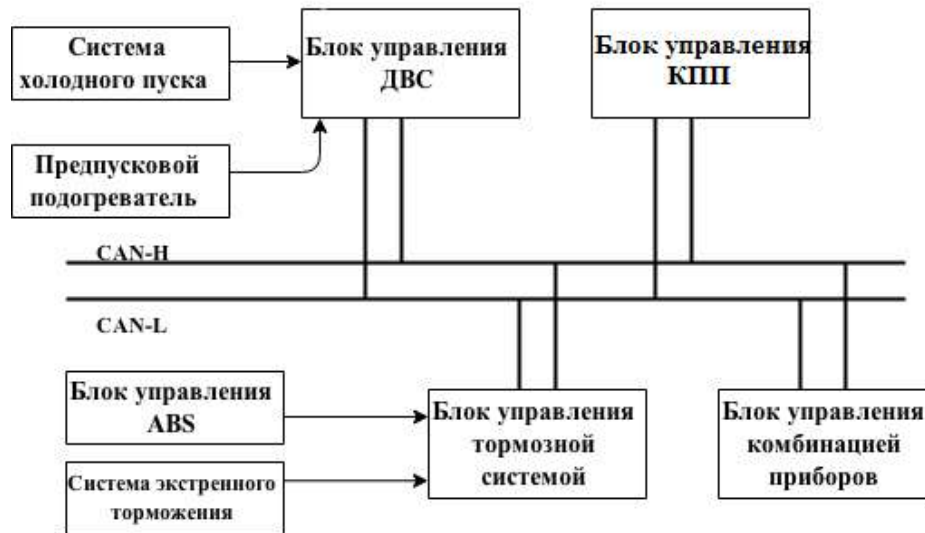
Рисунок 2.8 – Топология схемы бортовой информационной системы с «общей шиной».
