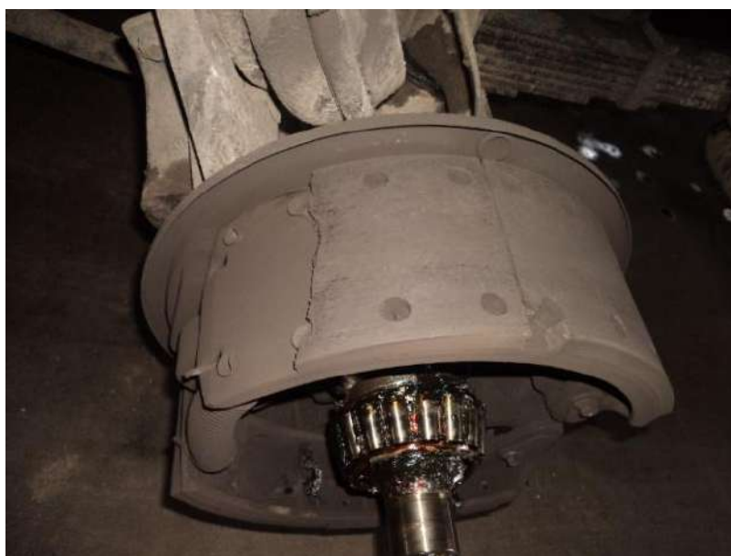
Рисунок 1.4 – Срыв фрикционной накладки тормозной колодки «КамАЗ»
