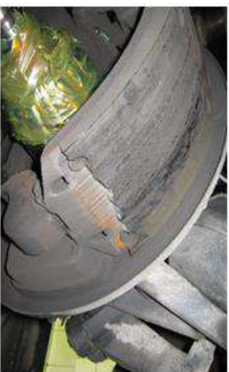
Срыв фрикционной накладки, вследствие перегрева
