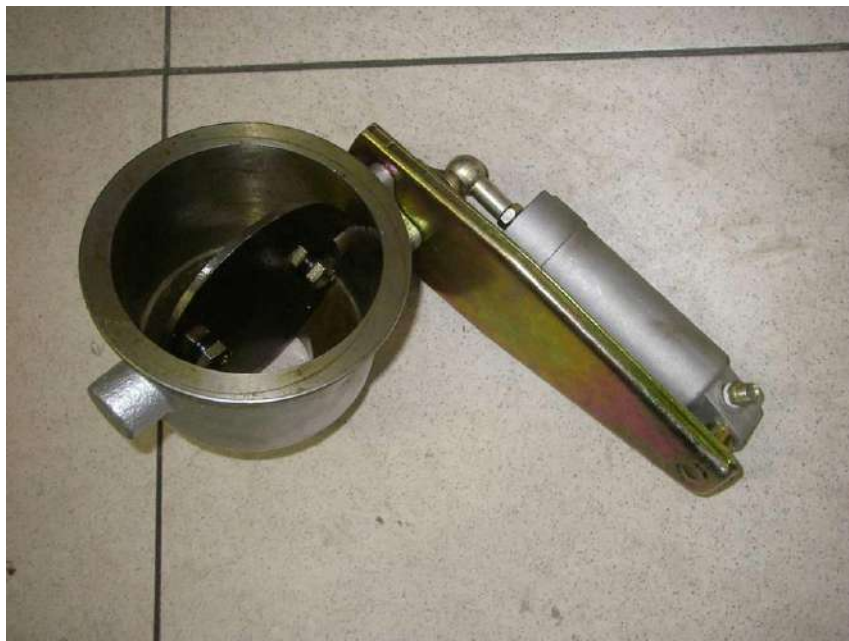
Рисунок 2.16 – Горный тормоз автомобиля КамАЗ
