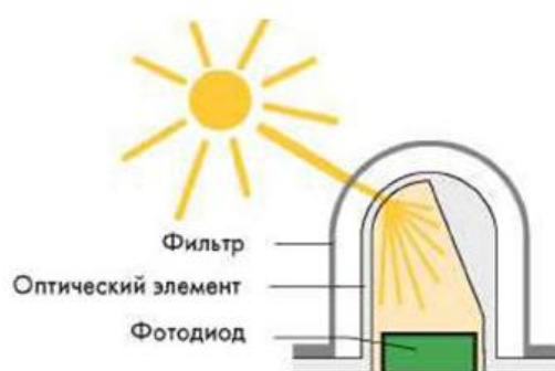
Рисунок 5 –Фотодатчик при попадании солнечного света под углом
