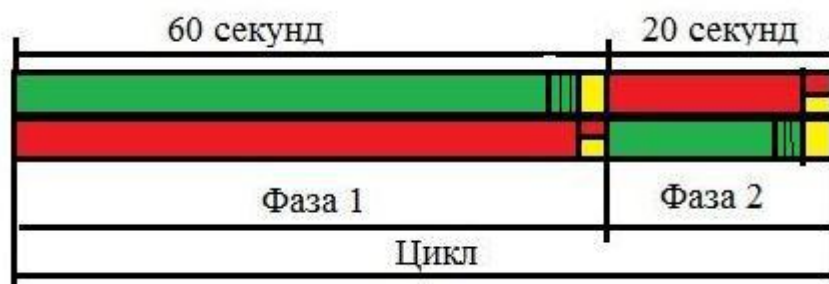
Рисунок 16 – Временная диаграмма переключения светофорной сигнализации на перекрестке улиц Хлебозаводская – Северный луч
