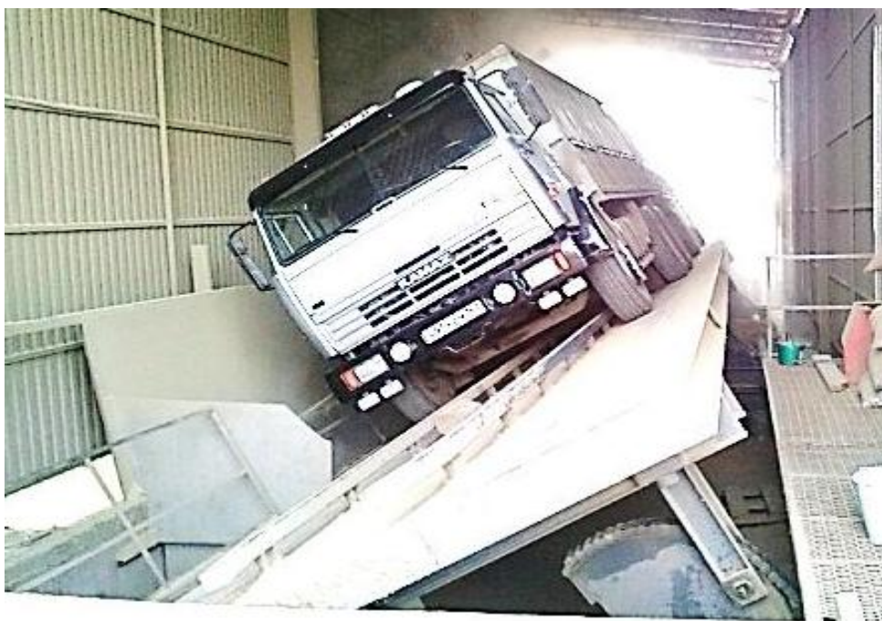
Рисунок 1.10 – Разгрузка бортового автопоезда на подъемном устройстве
