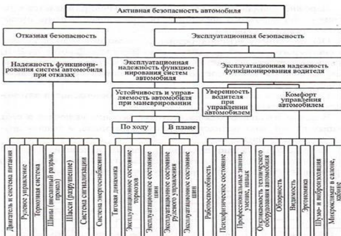
Рисунок 5 – Структурная схема активной безопасности автомобиля
