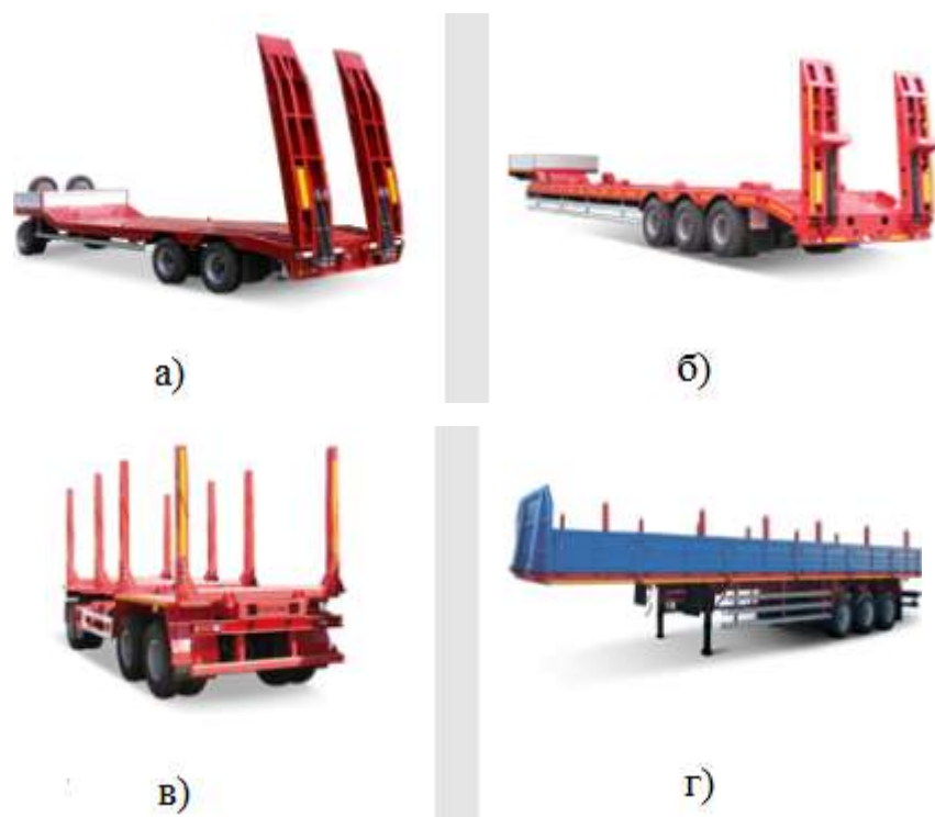
Рисунок 5 – Виды прицепной техники: а) прицепы тяжеловозы низкорамные; б) полуприцепы тяжеловозы высокорамные; в) прицепы и полуприцепы сортиментовозы ( лесовозы); г) бортовые полуприцепы и шасси
