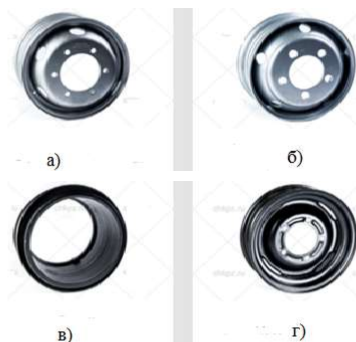
Рисунок 4 – Виды колес и дисков: а) колеса для автомобилей малой грузоподъемности; б) колеса для грузовых автомобилей, автоприцепов, автобусов с 15 град. посадочной полкой; в) колеса для большегрузных автомобилей и строительно-дорожной техники под односкатную ошиновку; г) колеса для с/х машин
