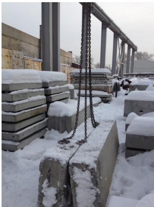
Рисунок 6 – Фотография размещения железобетонных изделий на складе
