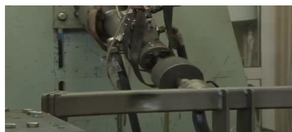
Испытание ТСУ на прочность
