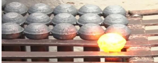
Заготовка после оковывания сферы
