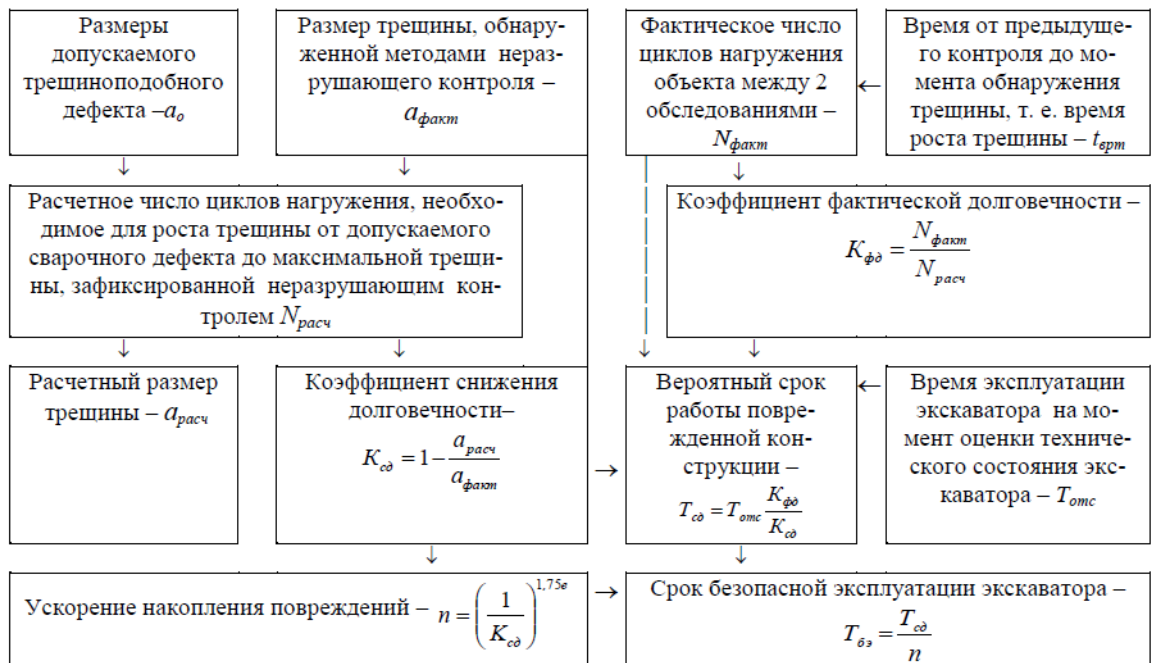
Рисунок 2.3 – Схема оценки остаточного ресурса (срока безопасной эксплуатации)
