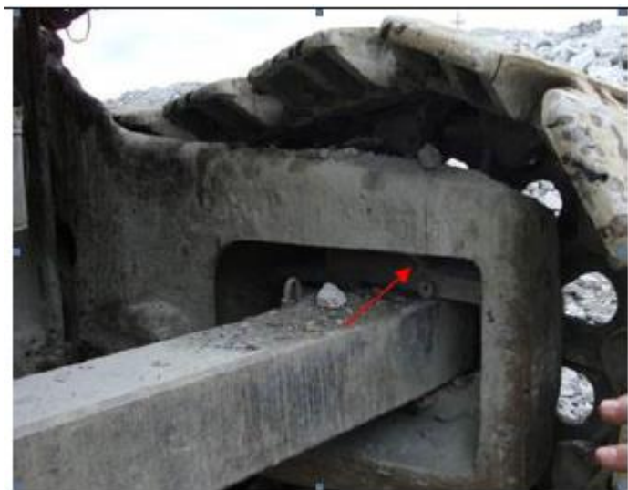
д) Трещина гусеничных рам в районе натяжных окон
