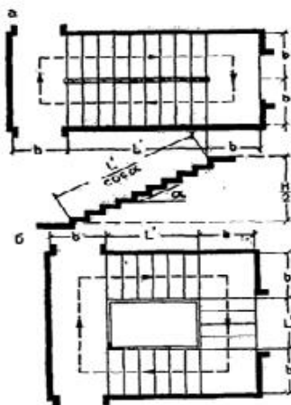
Рисунок 3.4 – Расчетная длина пути по лестнице. Обозначения: а – двухмаршевая лестница; б – трехмаршевая лестница
