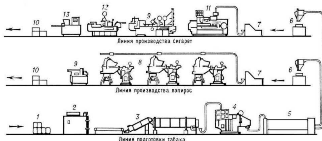
Рисунок 1 – Технологическая схема табачного производства:
