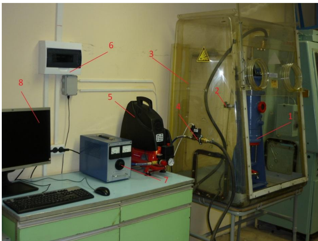
Рисунок 1 – Общий вид установки согласно ГОСТ 12.1.044-89 (2001): 1 – реакционный сосуд; 2 – датчик давления; 3 – вытяжной шкаф; 4 – электромагнитный клапан; 5 – компрессор; 6 – блок питания; 7 – регулятор мощности; 8 – ПЭВМ
