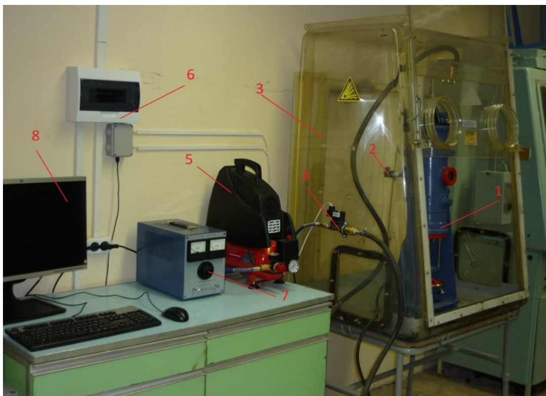
Рисунок 17 – Общий вид установки согласно ГОСТ 12.1.044-89 (2001): 1 – реакционный сосуд; 2 – датчик давления; 3 – вытяжной шкаф; 4 – электромагнитный клапан; 5 – компрессор; 6 – блок питания; 7 – регулятор мощности; 8 – ПЭВМ
