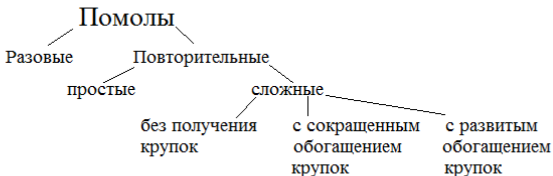
Рисунок 6 – Классификация помолов зерна
