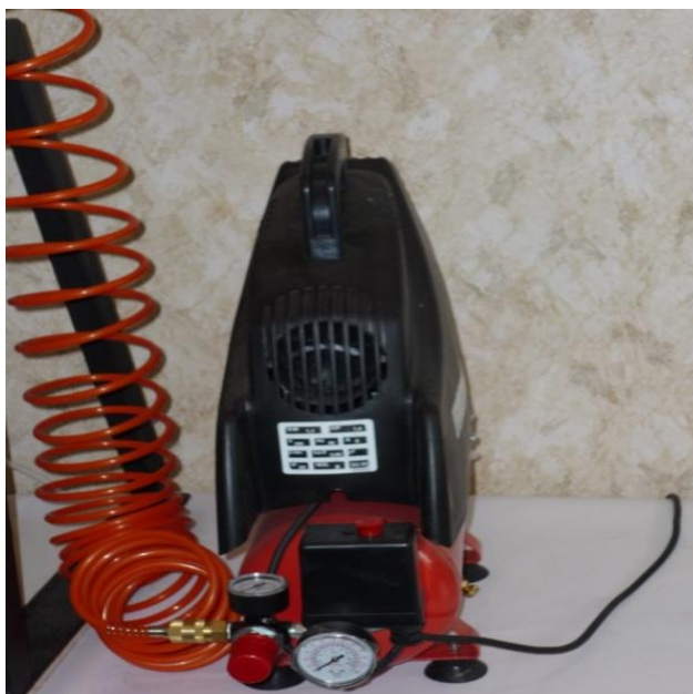
Рисунок 19 – Компрессор системы приготовления и распыления материала
