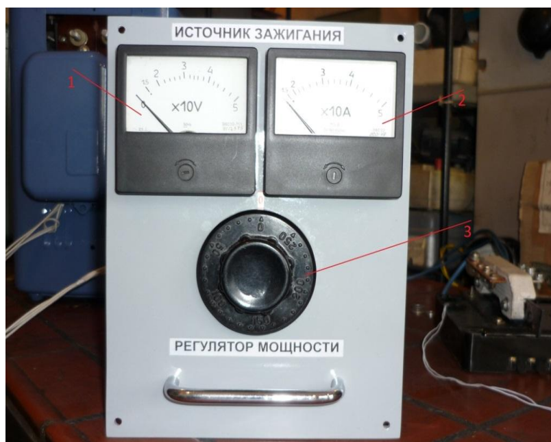
Рисунок 18 – Источник зажигания и регулятор мощности: 1 – вольтметр; 2 – амперметр; 3 – ЛАТР-1М
