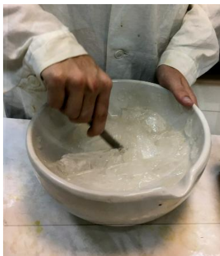
Рисунок 2.7 – Смешивание компонентов охлаждающей смеси
