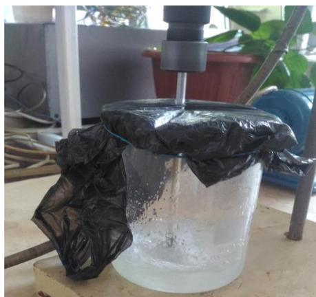
Рисунок 17 – Процесс механического перемешивания раствора
