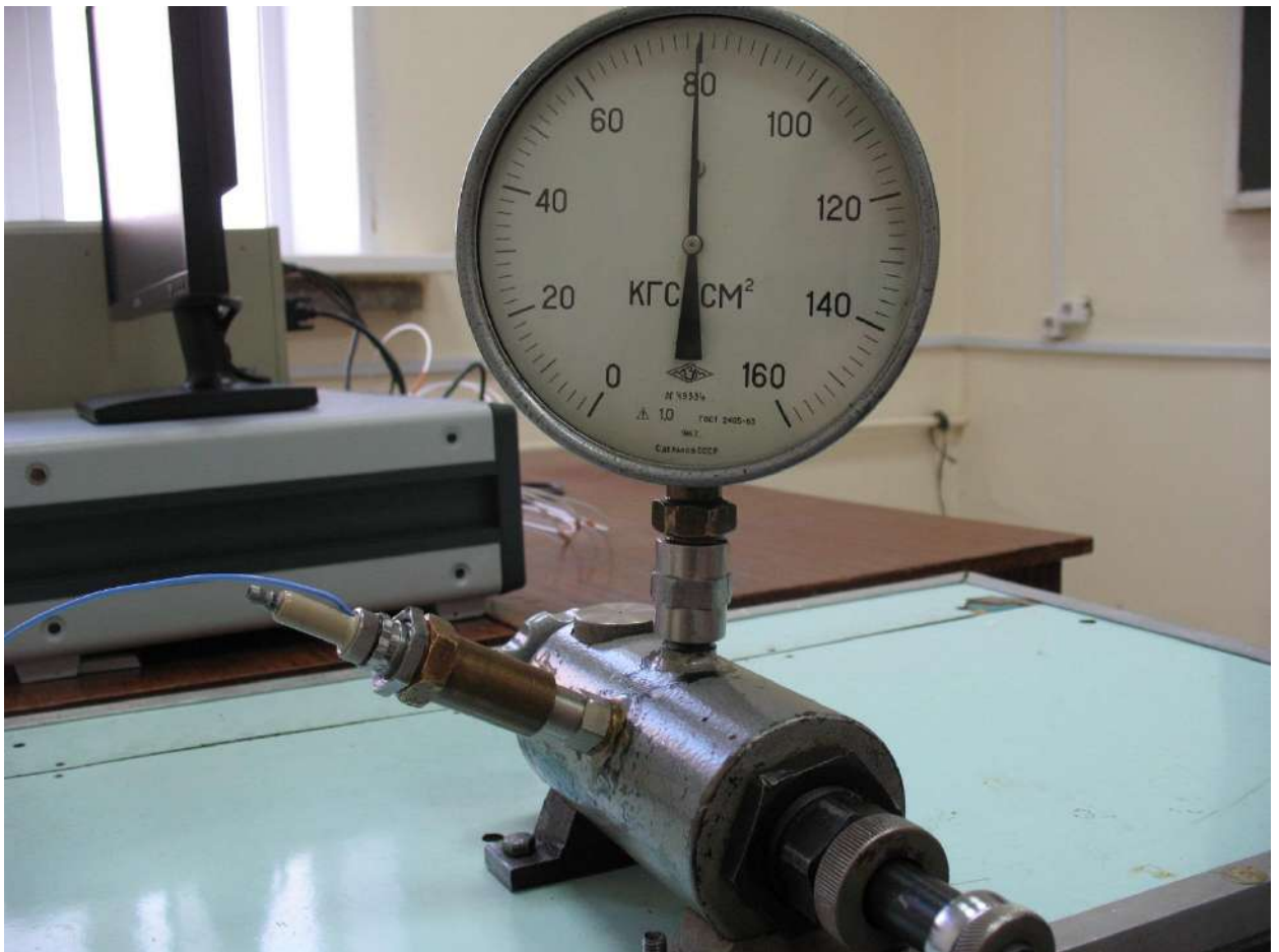
Рисунок 18 – Масляный пресс с датчиком давления фирмы AVL вмонтированным в свечу зажигания
