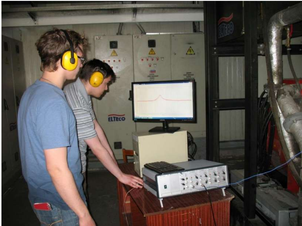
Рисунок 24 – Получение характеристики изменения давления в цилиндре двигателя
