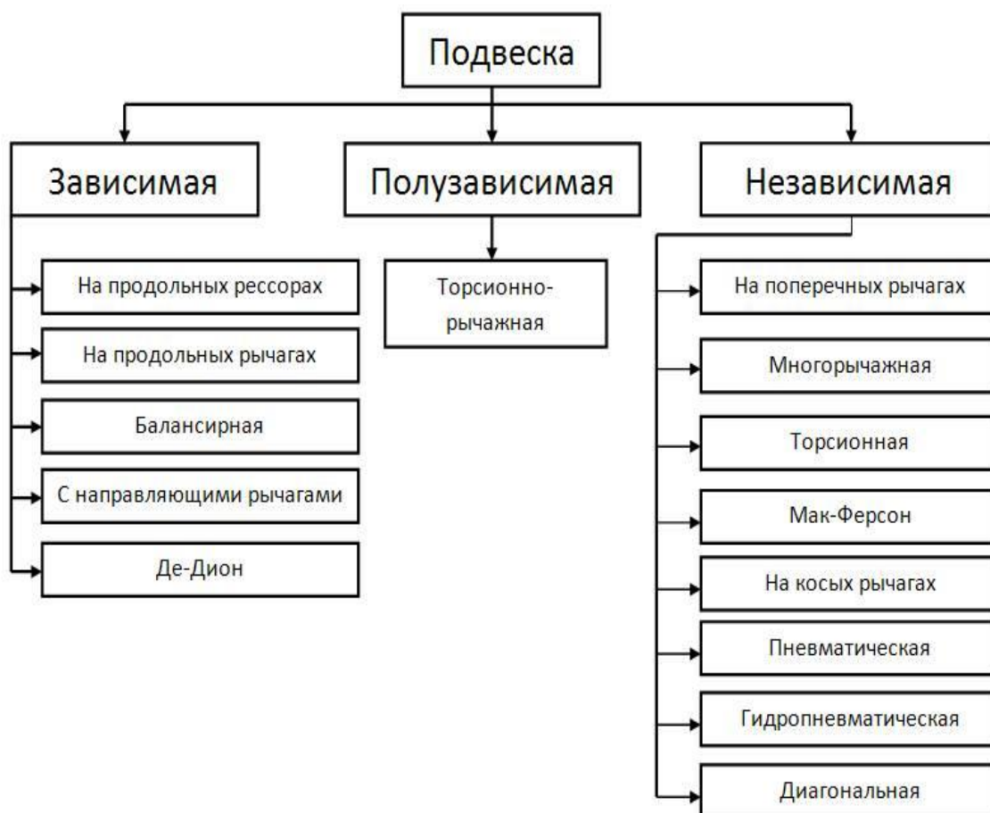
Рисунок 1.1 – Классификация подвесок автомобильного транспорта
