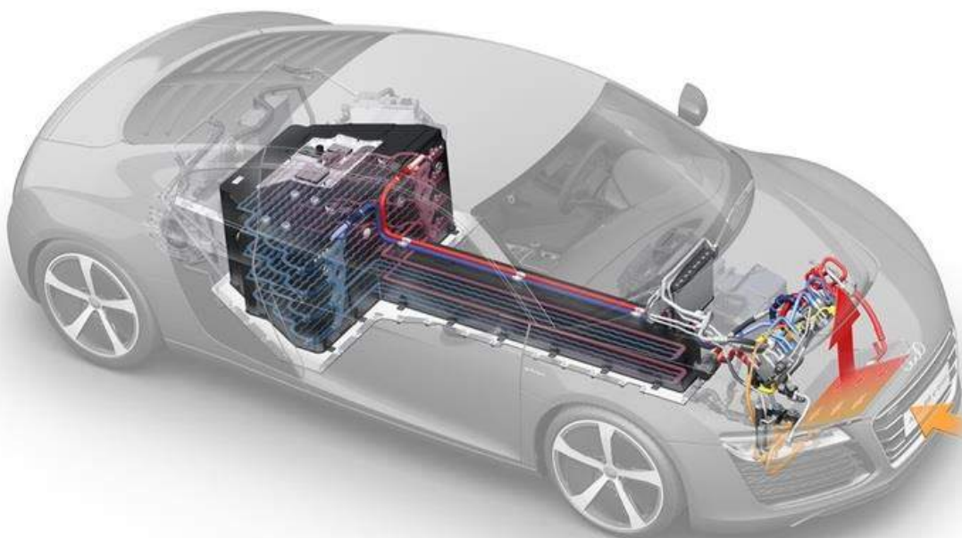
Рисунок 1.5 – Система принудительного охлаждения аккумуляторных батарей
