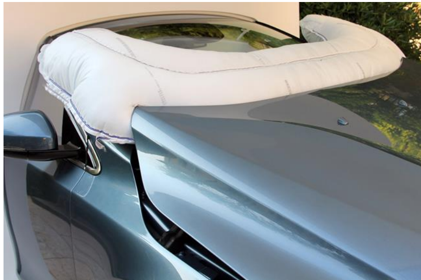
Рисунок 2.3- Пример открывания капота и надувание подушки
