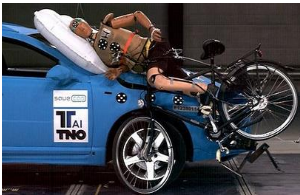
Рисунок 1.1 – Пример установки внешней подушки безопасности
