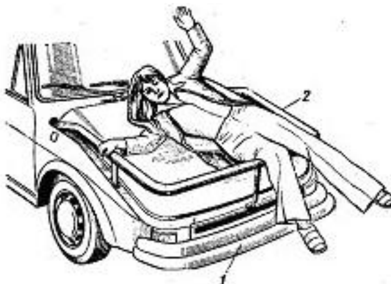
Рисунок 2.2 –Защитная рамка, устанавливающая ранее английских автомобилях 1-автомобиль; 2-защитная рамка
