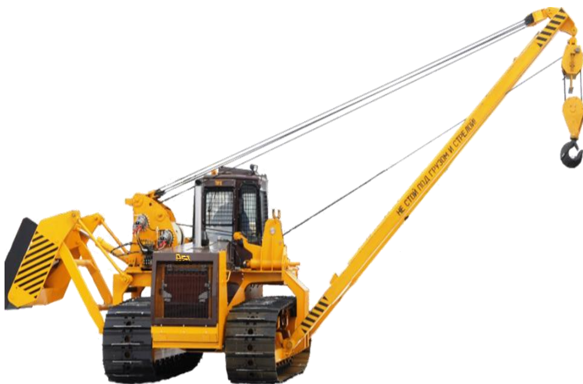
Рисунок 3 – Трубоукладчик ТГ 20.32Е2
