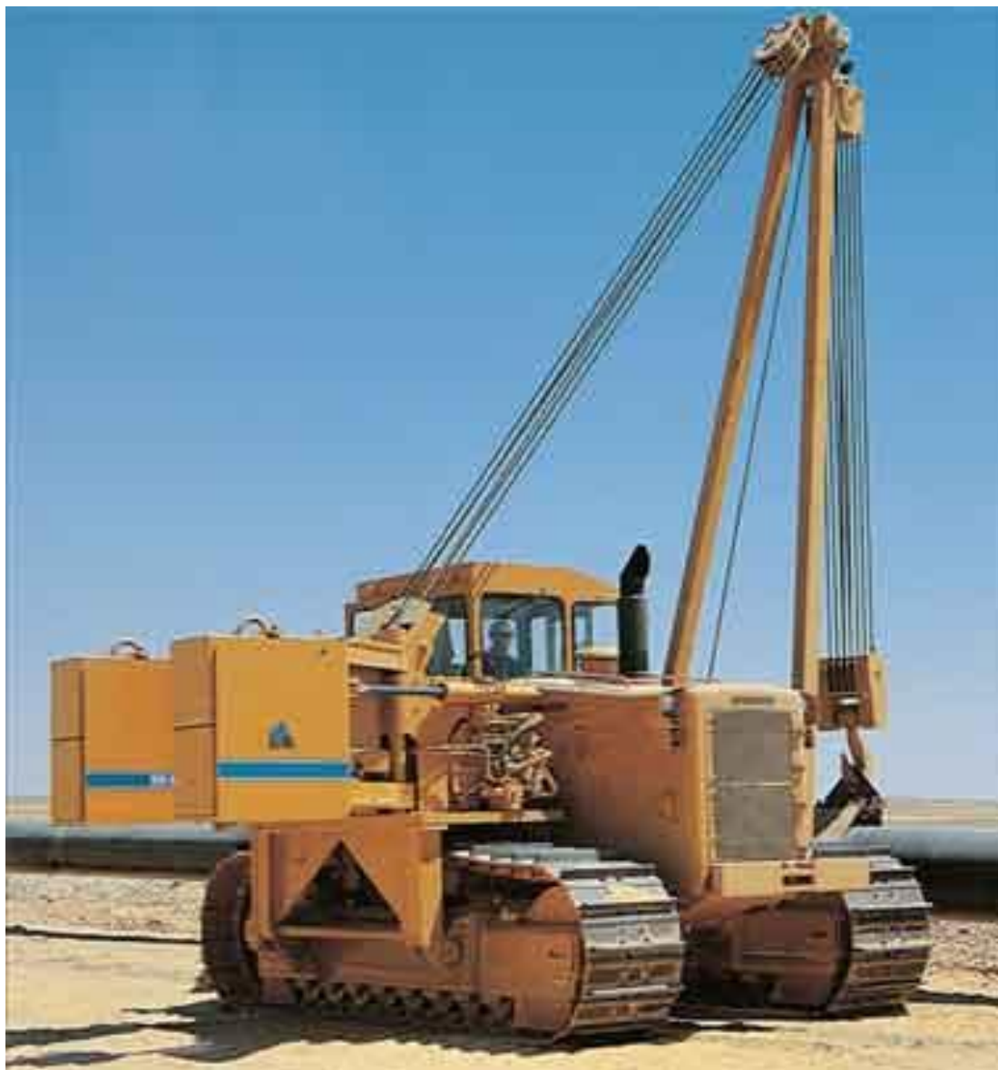
Рисунок 7 – Трубоукладчик Dressta SB-85
