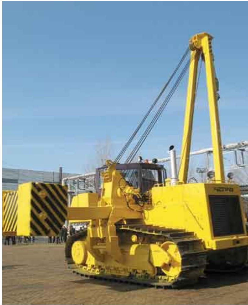
Рисунок 5 – Трубоукладчик CATERPILLAR HEAVY-511
