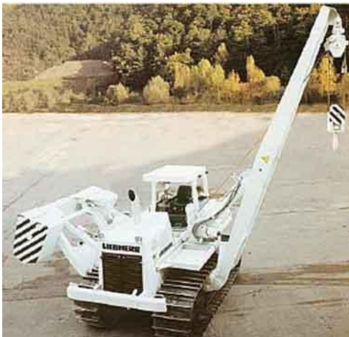
Рисунок 6 – Трубоукладчик Liebherr RL 52 Litronic
