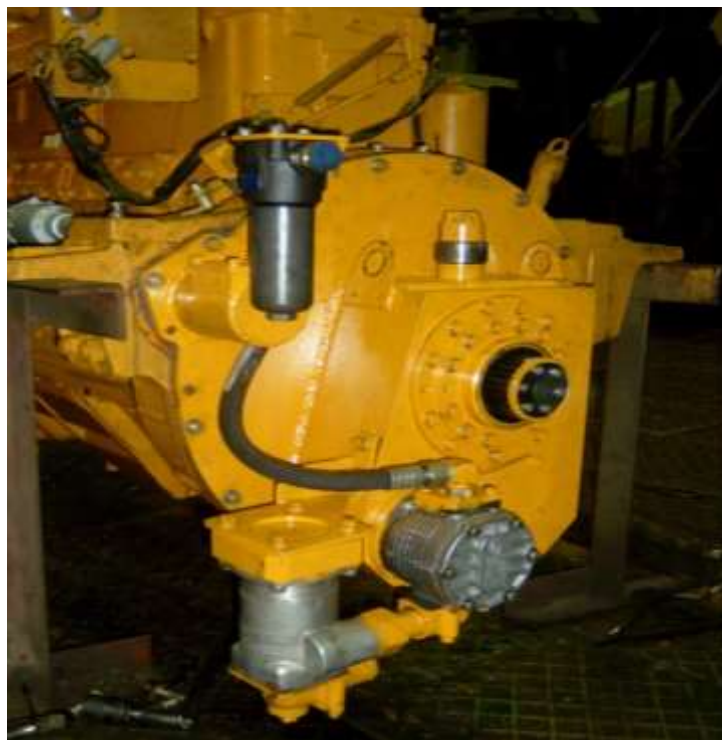
Рисунок 2.5 – Установка упругой муфты на двигатель
