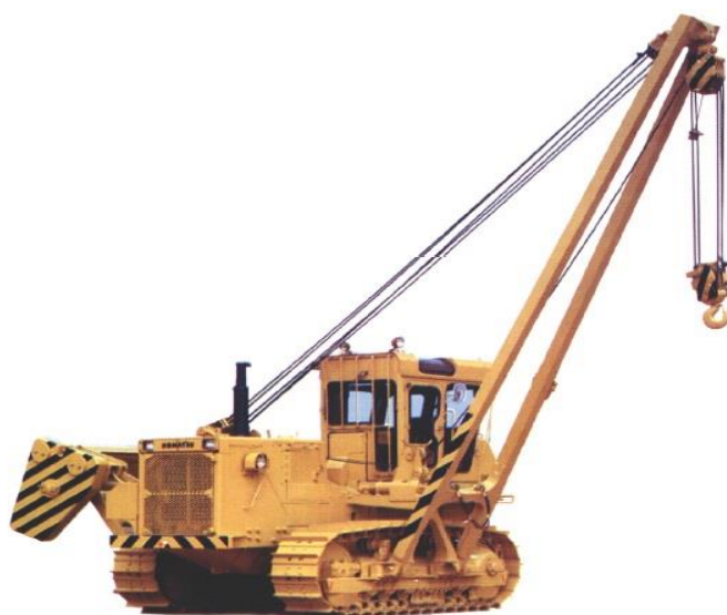
Рисунок 1.17 – Кран-трубоукладчик Komatsu D85C-21
