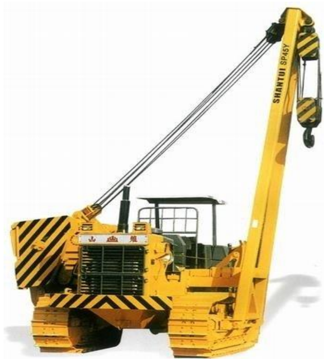
Рисунок 1.15 – Кран-трубоукладчик SHANTUI SP45Y
