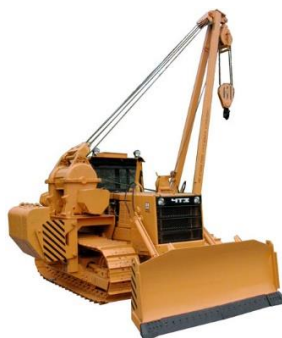
Рисунок 2.1. – Кран-трубоукладчик ТР12.22.01 с не выдвигаемым противовесом
