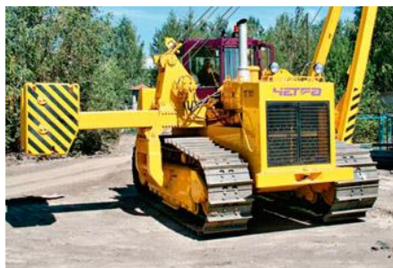
Рисунок 2.8 – Кран-трубоукладчик ЧЕТРА ТГ-511 с противовесом, работающим по принципу «телескопа».
