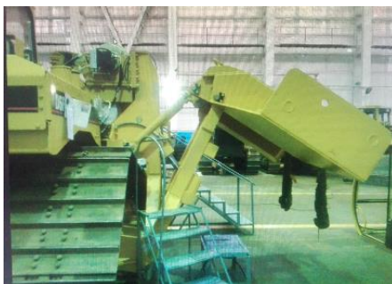
Рисунок 2.9 – Кран-трубоукладчик с противовесом, складывающимся по принципу «книжки» с измененной кинематической схемой.
