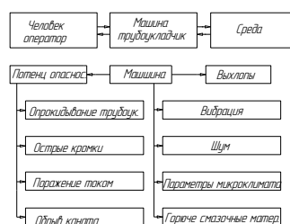
Рисунок 6.2 - Анализ вредных факторов трубоукладчика ТР20В
