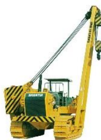
Рисунок 1.8 – Кран-трубоукладчик Shantui SP45Y
