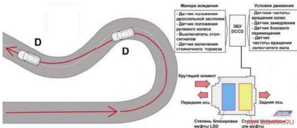
Рисунок 1.22 – Режим движения автомобиля: движение в повороте – выход
