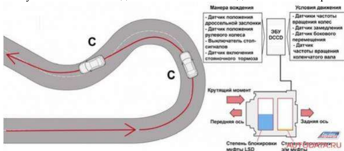
Рисунок 1.22 – Режим движения автомобиля: движение в повороте – выход
