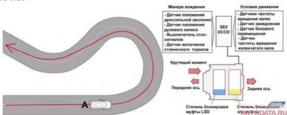
Рисунок 1.20 – Режим движения автомобиля: начало входа в поворот
