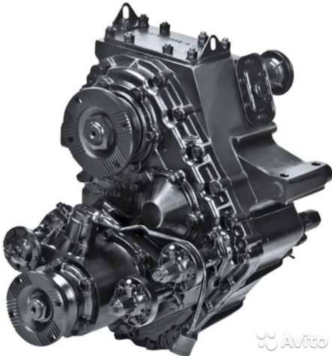
Рисунок 6.2 – Раздаточная коробка КамАЗ-4310
