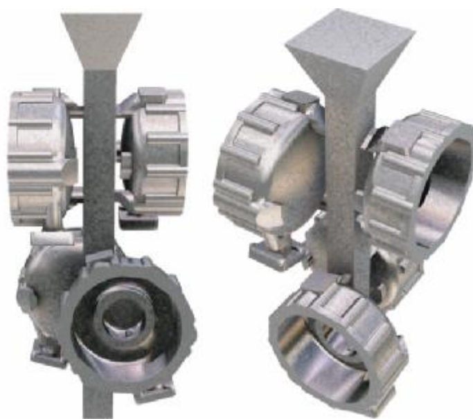
Рисунок 4.12 – Литниковая система для отливки «корпус»
