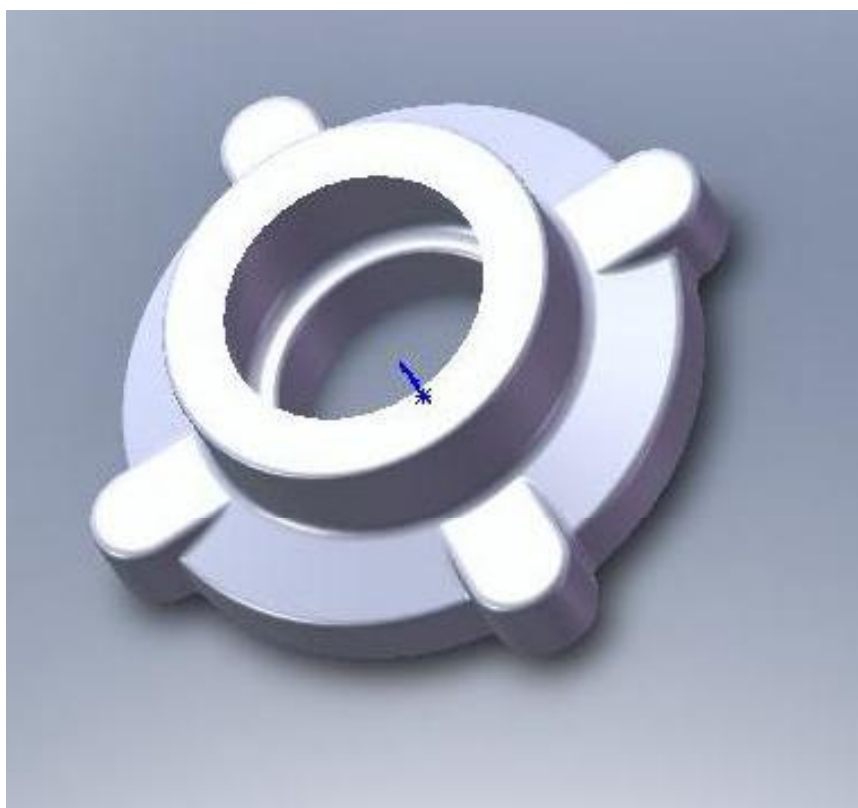
Рисунок 2.6 – 3D модель отливки «Колонка»
