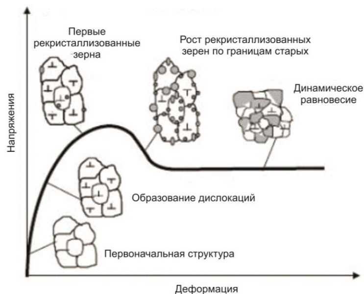
Рисунок 1.7 – Диаграмма горячей деформации, сопровождаемой динамической рекристаллизацией [6]
