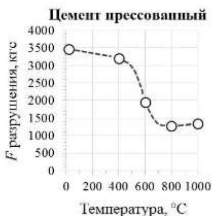
Рисунок 3.27 – Прочность и весовая плотность брикетов из прессованного цемента после нагрева до различных температур
