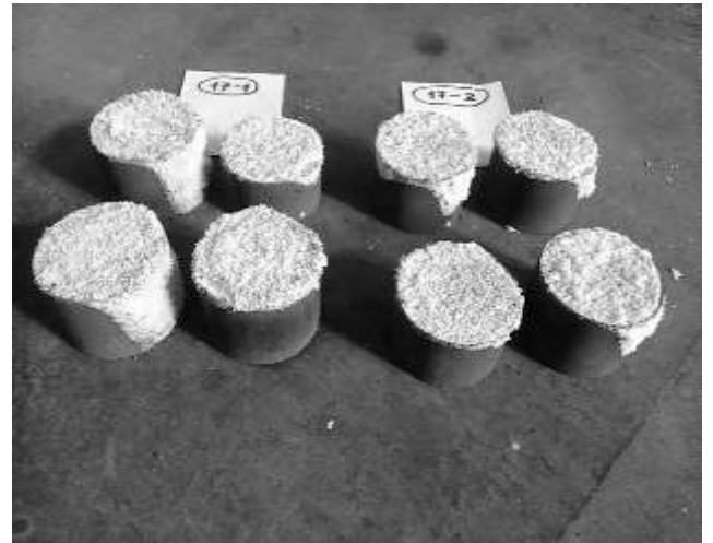
Отпрессованные брикеты после сушки на воздухе (на батарее, прогрев снизу-вверх). На верхнем торце брикетов, в месте выхода паров воды, появилась «шуба» из кристаллов сульфита натрия \text{Na}_2\text{SO}_3 .
