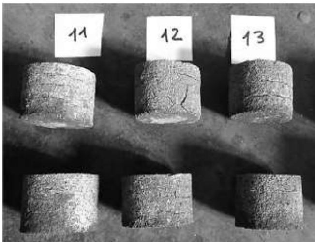
Разрушенные брикеты: Брикеты после нагрева до 1000\text{ }^\circ\text{C} верхний ряд – брикеты после 1000\text{ }^\circ\text{C} нижний ряд – брикеты при 20\text{ }^\circ\text{C} Рисунок 3.17 – Влияние количества воды на брикеты из шихты
