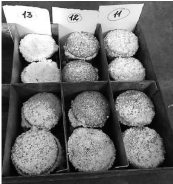
Отпрессованные брикеты после сушки на воздухе (на батарее, прогрев снизу-вверх). На верхнем торце брикетов, в месте выхода паров воды, появилась «шуба» из кристаллов сульфита натрия \text{Na}_2\text{SO}_3 .
