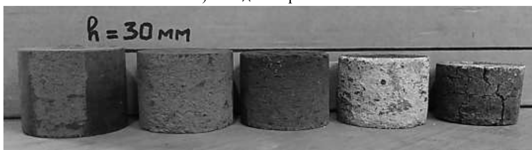
б) брикеты ПШ + 12 мл жидкого стекла + 26 мл воды после нагрева
