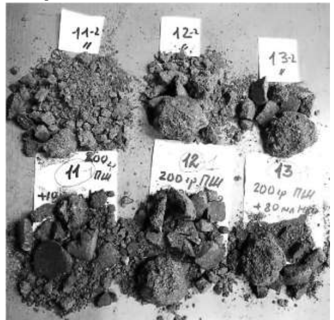
Разрушенные брикеты: Брикеты после нагрева до 1000\text{ }^\circ\text{C} верхний ряд – брикеты после 1000\text{ }^\circ\text{C} нижний ряд – брикеты при 20\text{ }^\circ\text{C} Рисунок 3.17 – Влияние количества воды на брикеты из шихты
