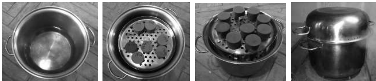
Рисунок 3.6 – Брикеты с цементом, пропарка в автоклаве с кипящей водой (3 часа)
