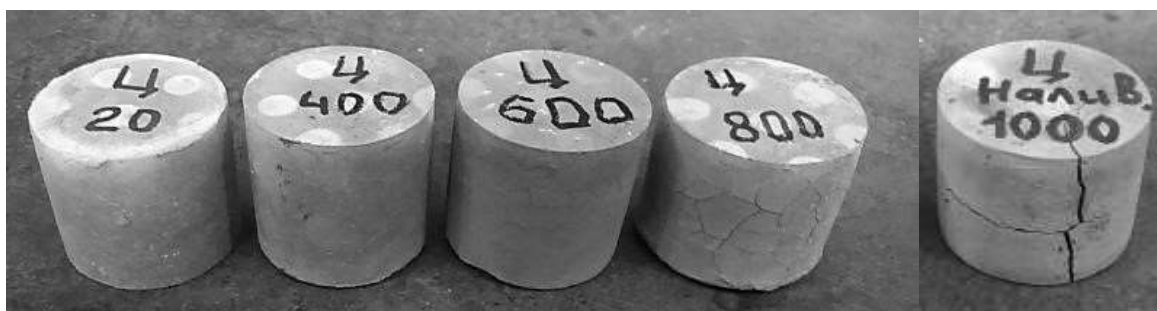
Рисунок 3.26 – Внешний вид брикетов из прессованного цемента после нагрева до различных температур
