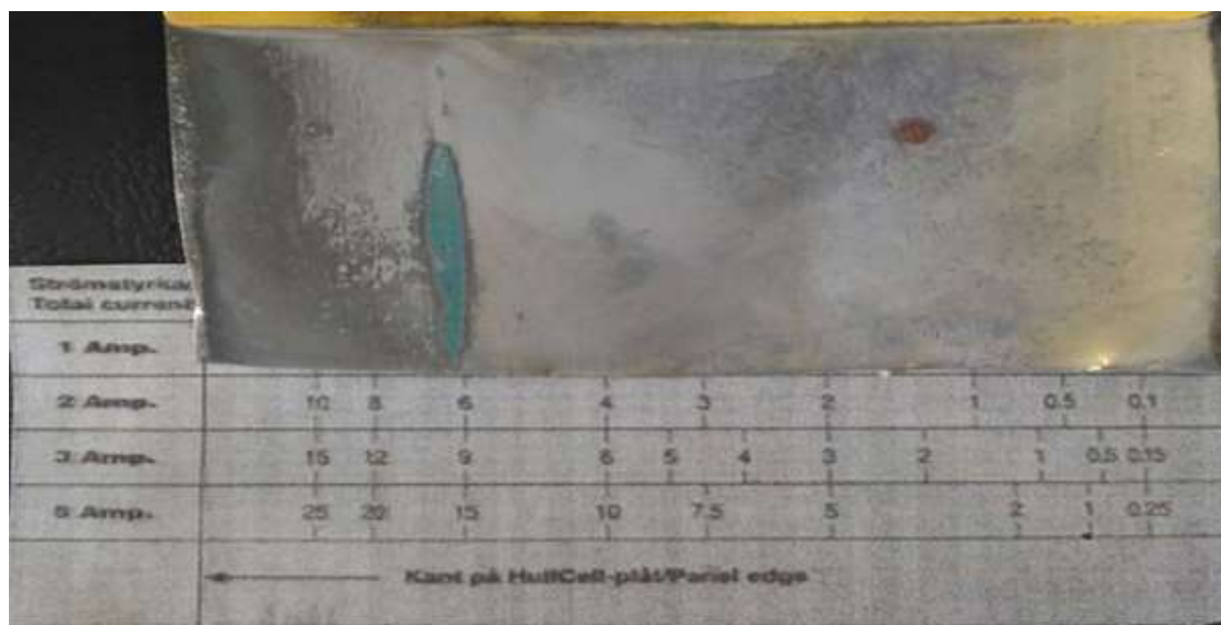
Рис.2.13. Латунная пластина с покрытием, осажденным в ячейке Хулла
