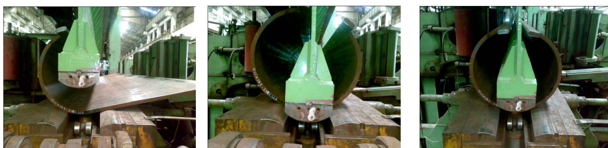
Рисунок 2.5 – Пошаговая формовка труб большого диаметра
