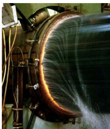
Рисунок 3.3 – Индуктор, выполняющий роль спрейера в системе водяного охлаждения отвода
