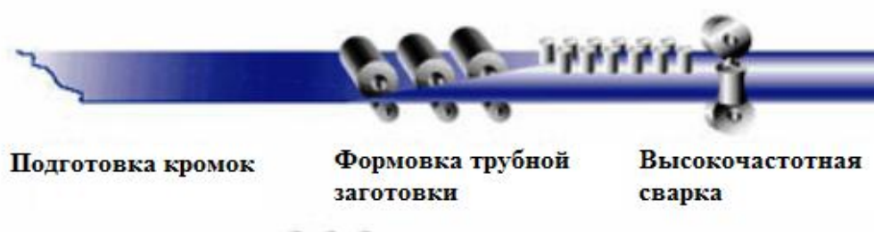
Рисунок 2.4 – Непрерывная валковая формовка труб с последующей электросваркой или индукционной сваркой кромок
