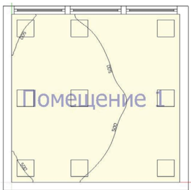
Рисунок 2.3 – График освещенности
