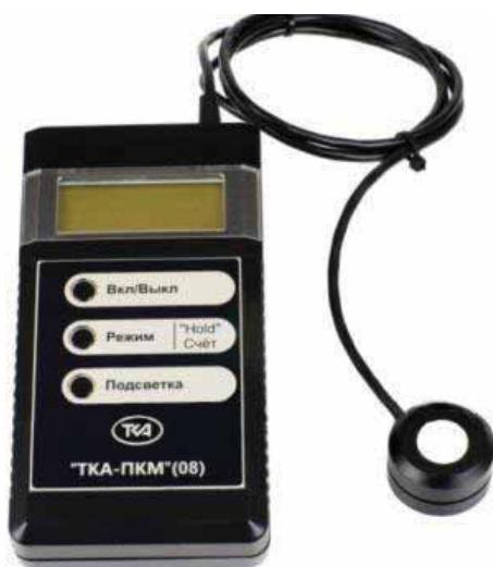
Рисунок 3.1 – Люксметр-пульсметр ТКА-ПКМ 08
