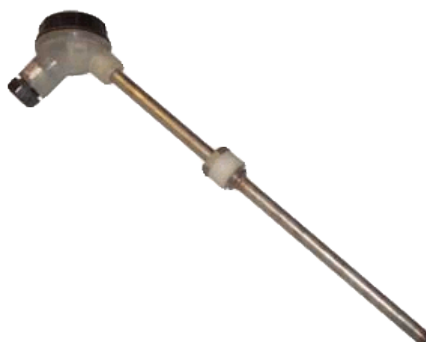
Рисунок 2.7 – Внешний вид хромель-алюмелевой термопары
