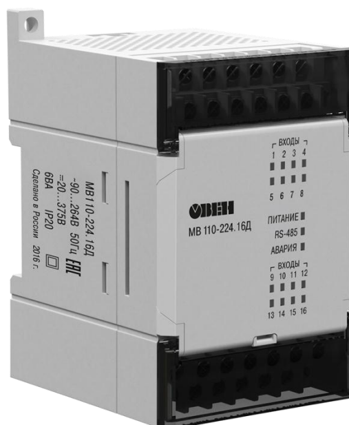
Рисунок 2.14 – Внешний вид модуля дискретного ввода ОВЕН МВ110-16Д
