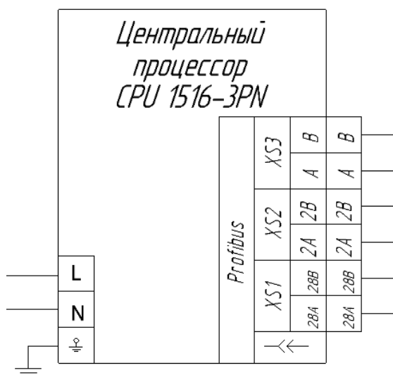
Рисунок 17 – УГО CPU 1516-3PN
