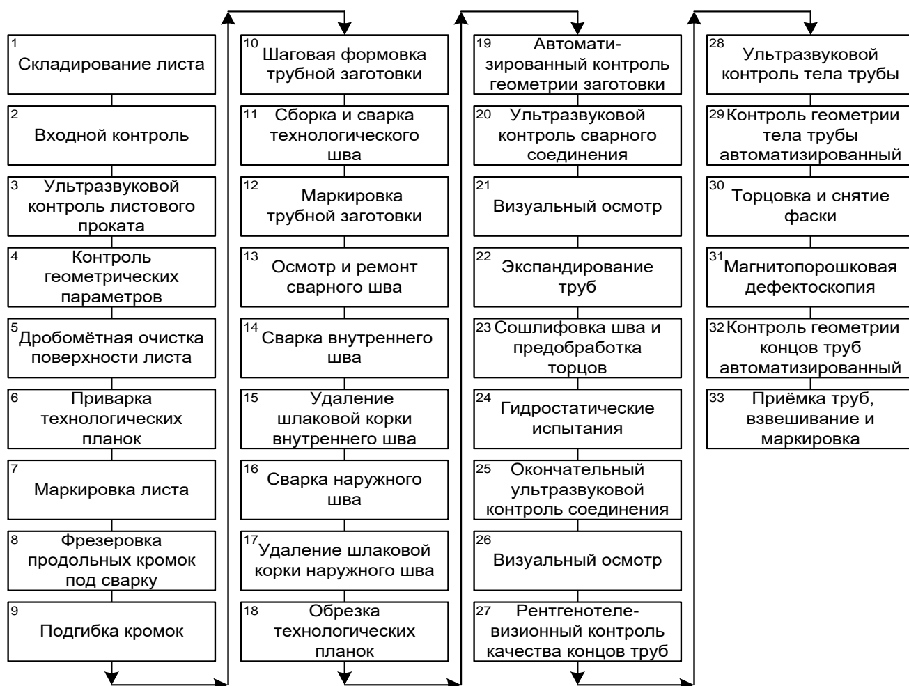
Рисунок 1.1 – Упрощенная схема технологического процесса изготовления электросварных труб цеха «Высота 239»
