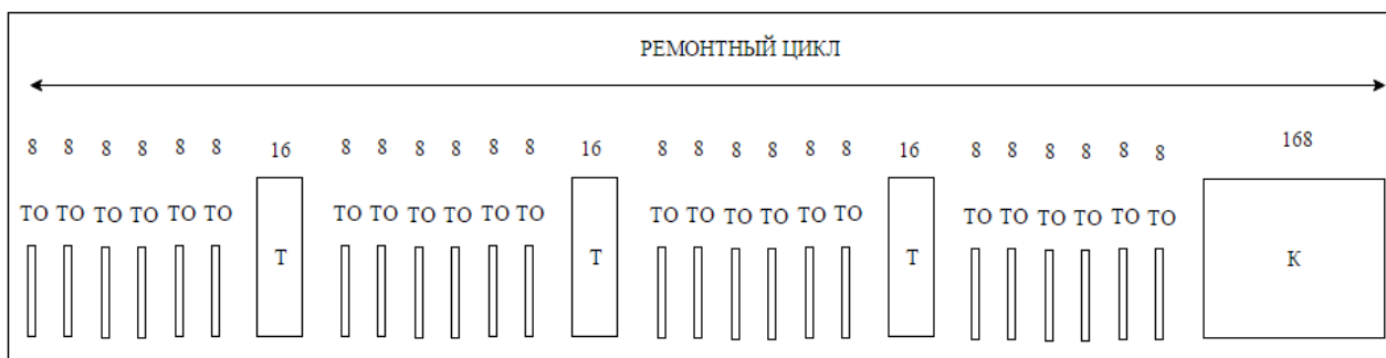
Рисунок 18 – Структура ремонтного цикла стана наружной сварки.
