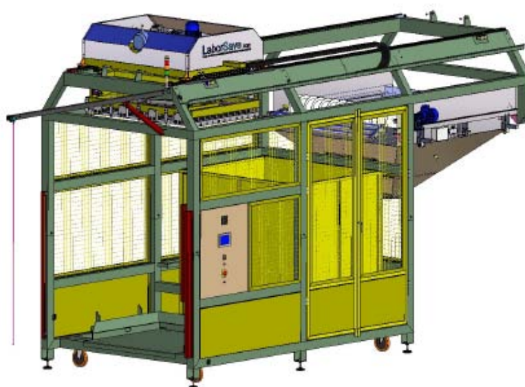
Рисунок 2 – Система LaborSave для автоматизированного опустошения мешков
