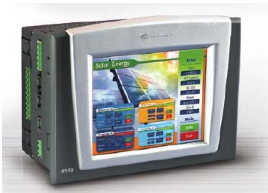
Рисунок 21 - Контроллер UNITRONICS VISION 570
