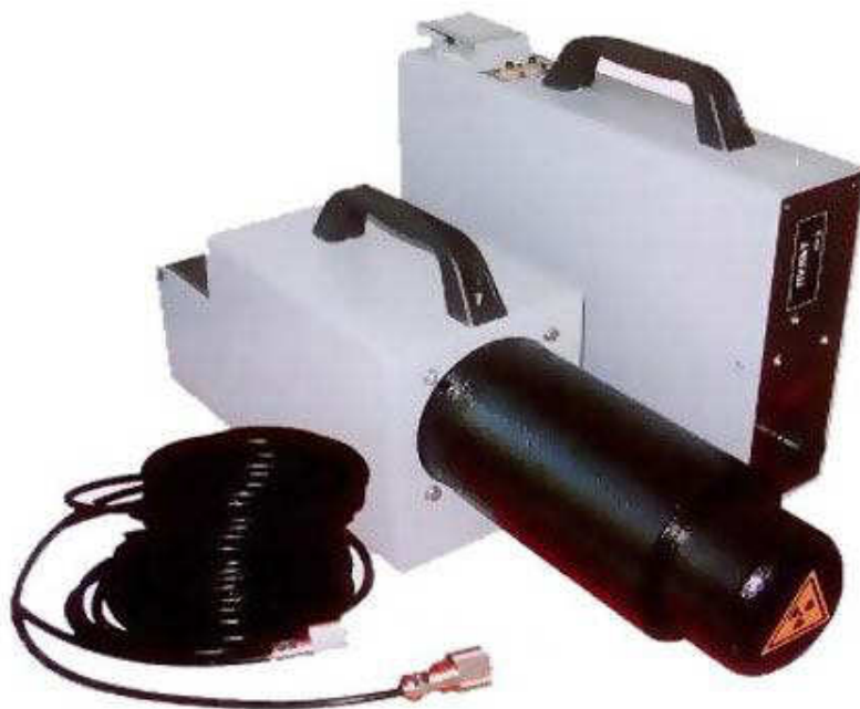
Рисунок 4.2 – Импульсный радиографический аппарат АРИНА-9
