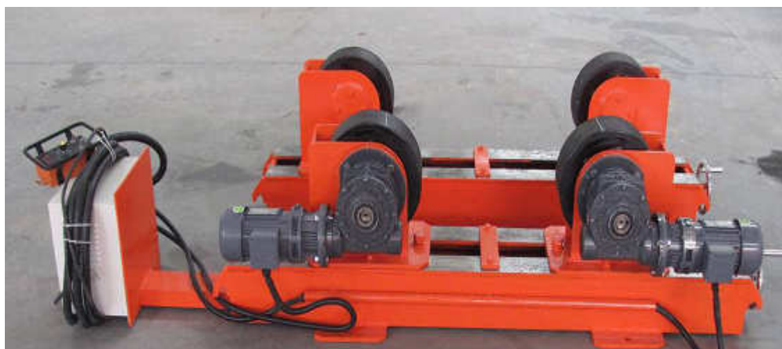
Рисунок 3.5 – Роликовые опоры КТ-5
