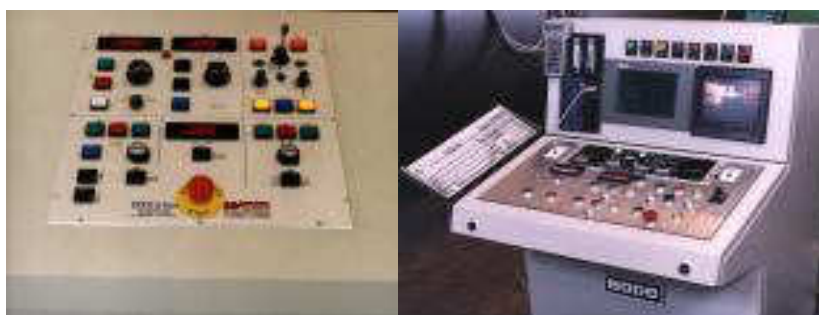
Рисунок 3.3 – Блок управления сварочной колонной
