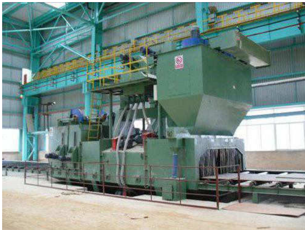
Рисунок 1.12 – Установка абразивоструйной очистки марки Siapro RC 2500×600
