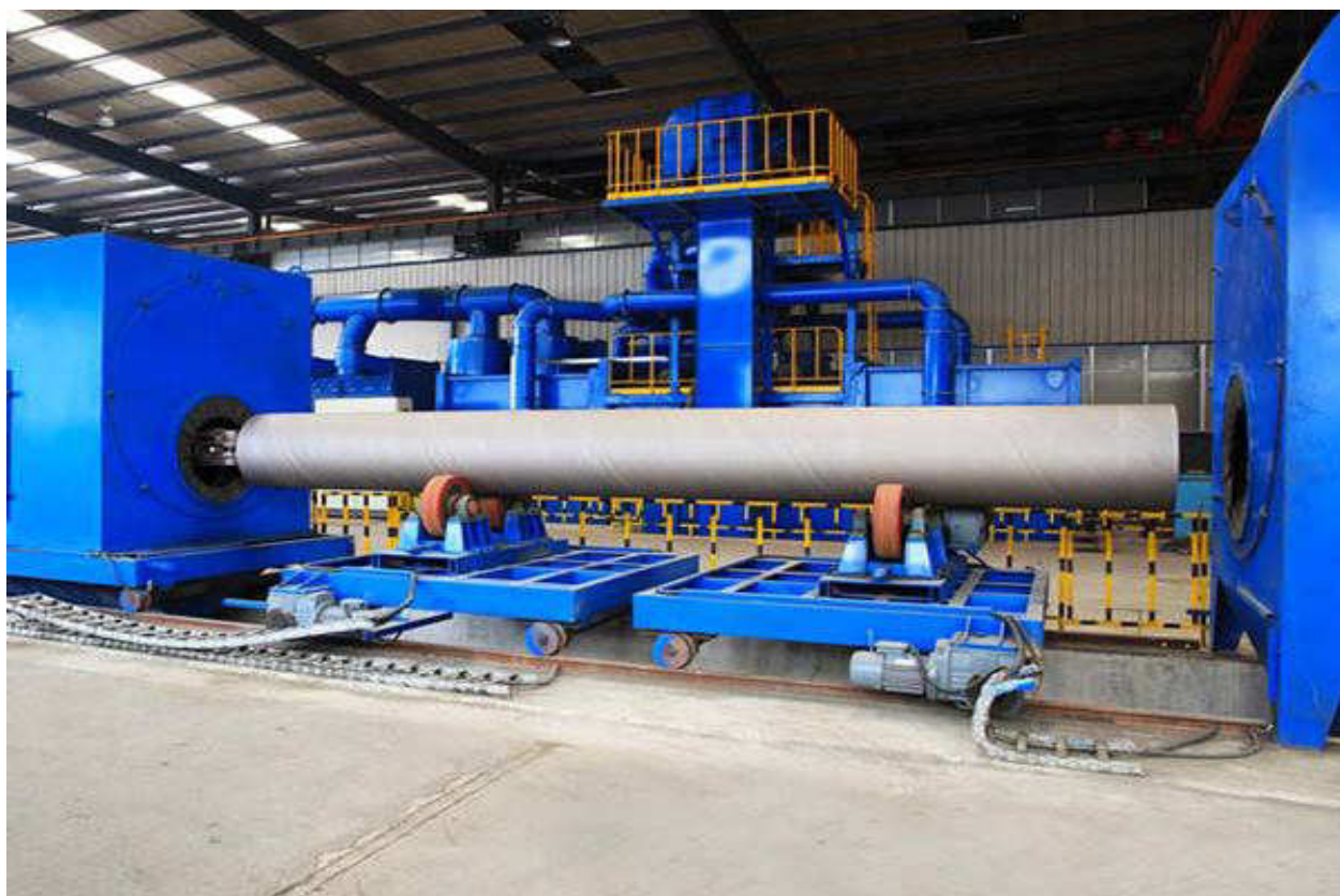
Рисунок 1.2 – Гидроклинер (подготовка поверхности трубы для покрытия изолирующим слоем)
