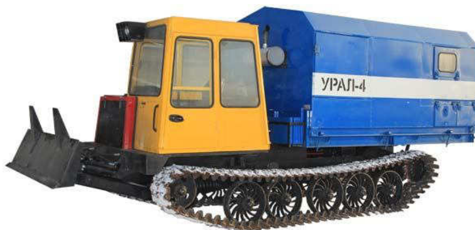
Рисунок 1.15 – Общий вид агрегата сварочного на гусеничном ходу марки УРАЛ-4 на базе трактора Т-147
