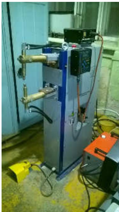
Рисунок 5.1 – Машина контактной сварки МТР-1601
