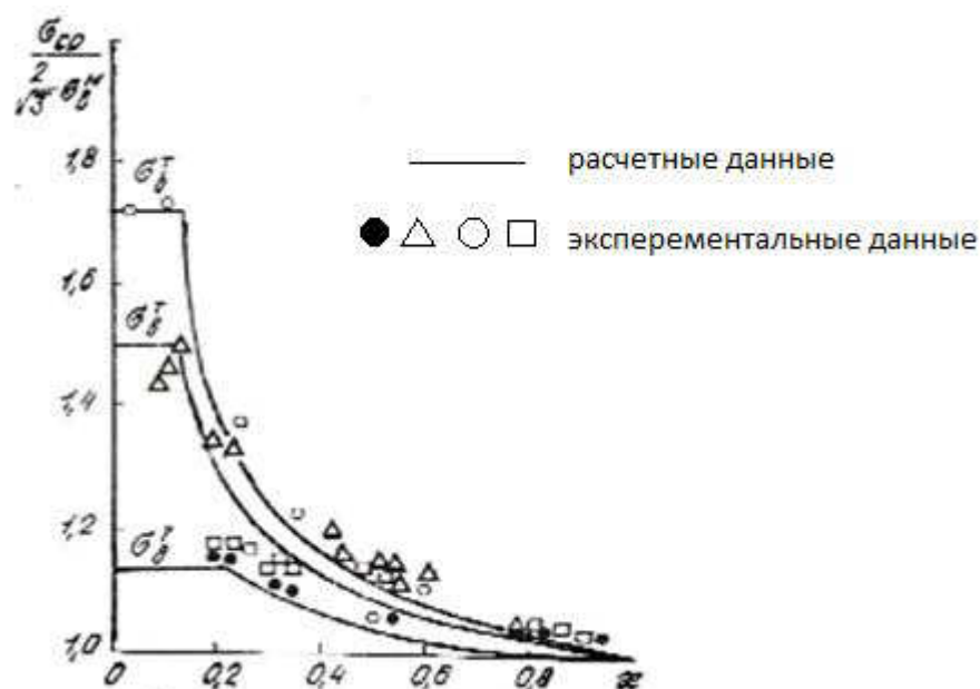
Рисунок 1.13 – Зависимость статической прочности сварных соединений от степени механической неоднородности и относительной толщины мягкой прослойки \chi
