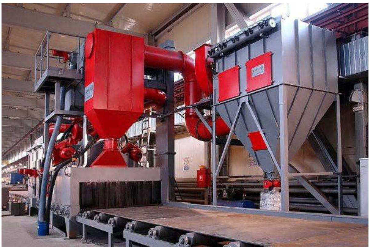
Рисунок 1.11 – Общий вид дробеметной установки Gostol P-2000x500
