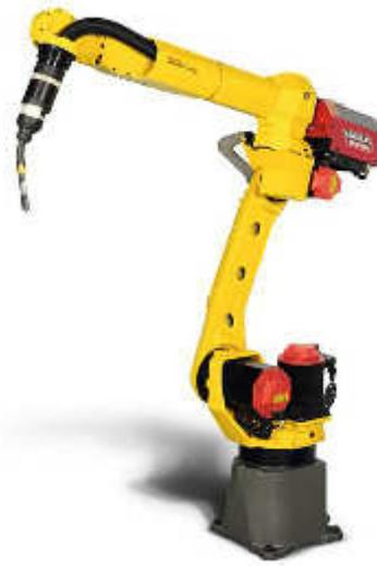
Рисунок 1.23 – Общий вид сварочного робота Fanuc Arc Mate 100iC
