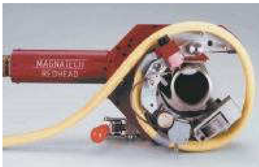
Рисунок 1.18 – Общий вид сварочной головки Magnatech Redhead 414 Описание устройства головки показано на рисунках 1.21-1.25.
