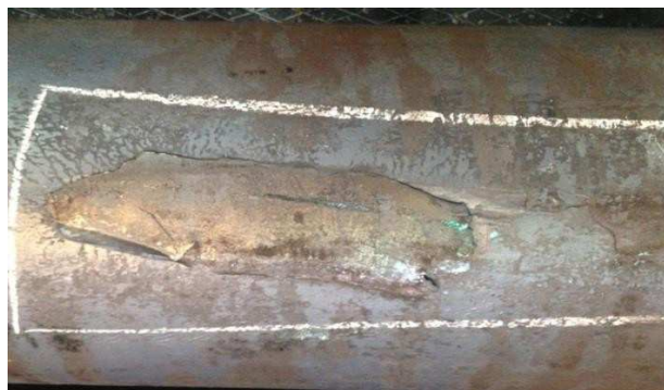
Рисунок 2 –Наружная плена на трубах из марки стали 09Г2С
