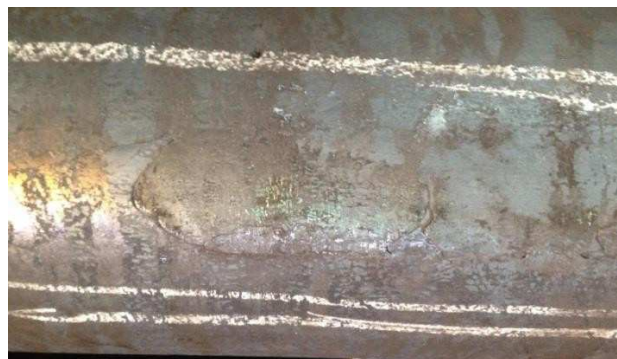
Рисунок 2 –Наружная плена на трубах из марки стали 09Г2С
