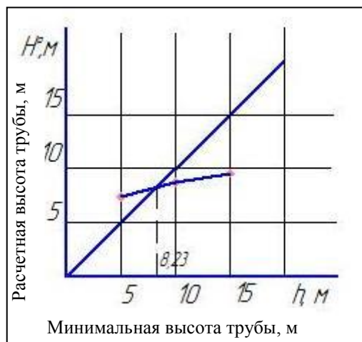
Рисунок 6.1 – Определение минимальной высоты дымовой трубы
