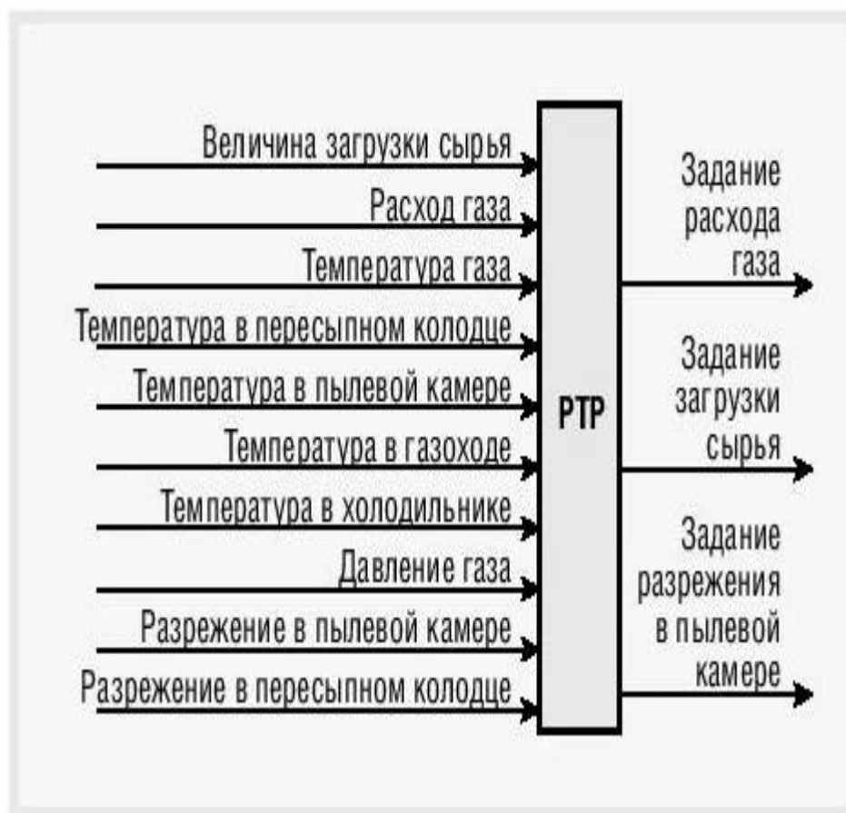
Рисунок 11.1 – Схема преобразования регулятора теплового режима
