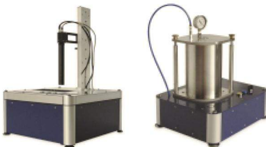
Рисунок 53 – Система ALPAGA для проведения гранулометрического и морфометрического анализа порошка
