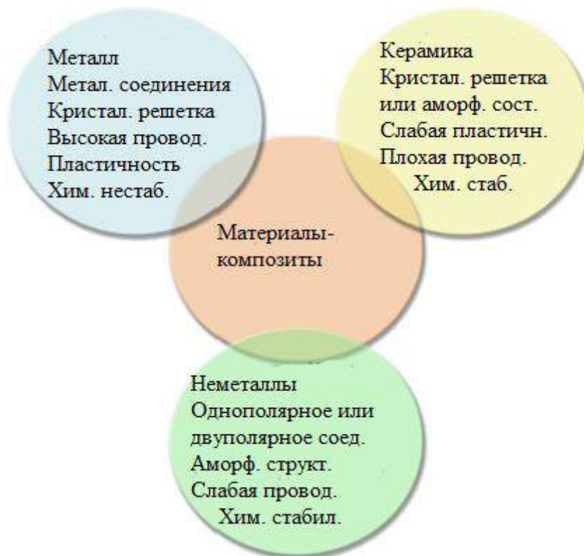
Рисунок 40 – Классификация композиционных материалов на основе металлов, неметаллов и керамики
